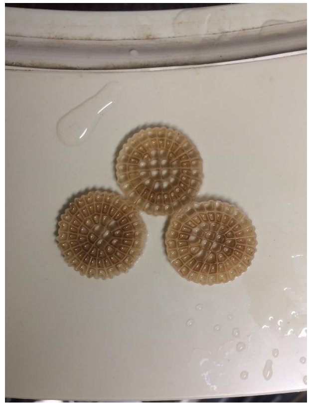
Figur 3. Biofilmsbärare i polyetylen.
